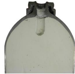
Schnitt einer C 2 H 2 -Flasche
