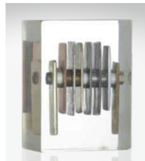
Corrosion dans l'eau de refroidissement.
