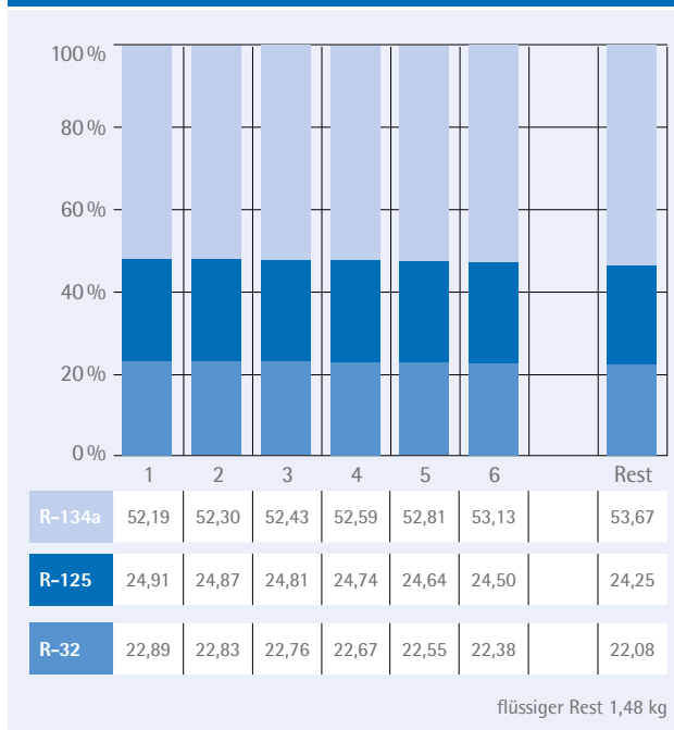
Zusammensetzung von R-407C bei Entnahme von 6 x 1,5 kg aus einer 12,3-Liter-/11-kg-Druckgasflasche bei 25 °C
