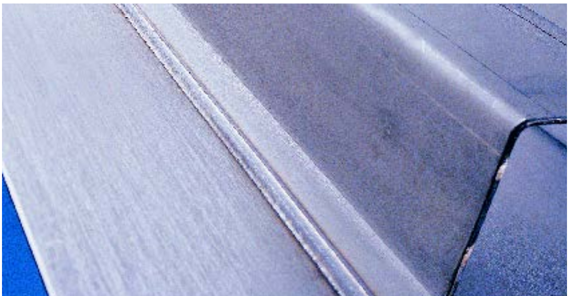
Perfekte Überlappnaht mit Sagox® SC: Dieses Hutprofil dient als Stabilisator für den Tank eines Straßentankwagens.
