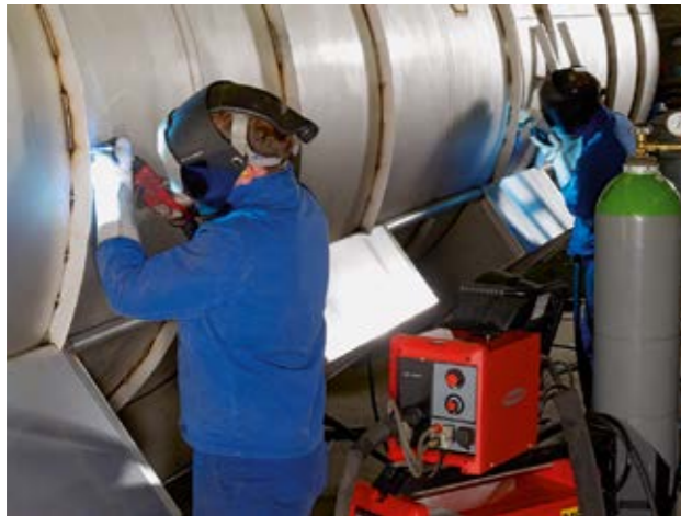
MAG-Schweißen eines Edelstahlbehälters mit Sagox® SC.
