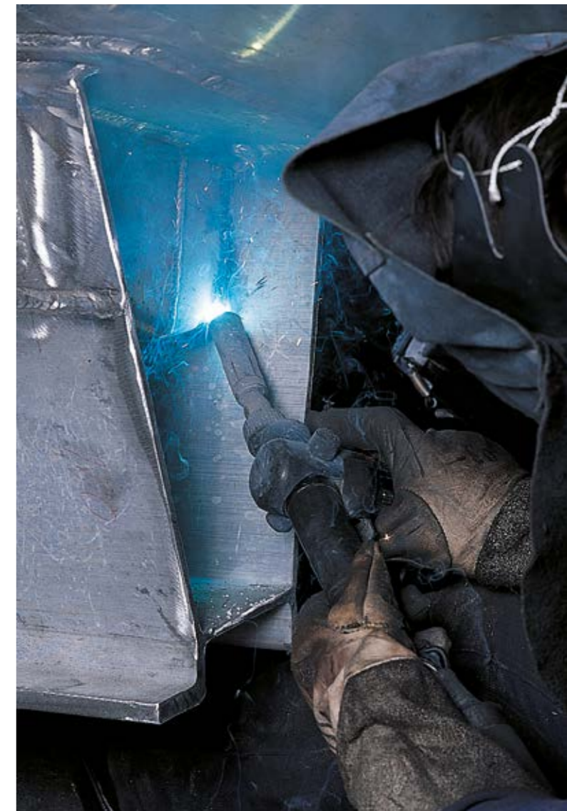
MIG-Schweißen unter Argon 4.6 von AlMg 4,5 Mn mit gleichartigem Zusatzwerkstoff.
