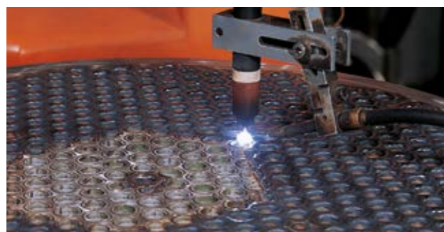
Beim WIG-Schweißen von Edelstahl (hier 1.4571) ist Argon als Schutzgas optimal geeignet.
