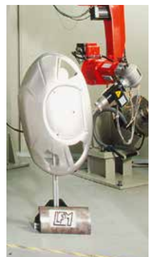
Nd:YAG-Laser mit Strahlübertragung zu einem Industrieroboter für die 3-D-Bearbeitung.
