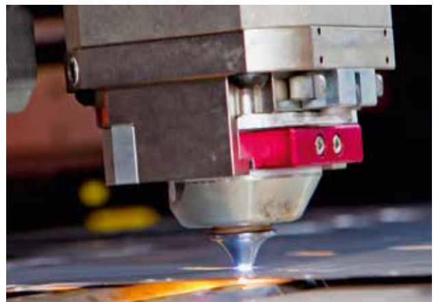
Kombiniertes Stanzen und Laserschneiden in Höchstgeschwindigkeit. Mit einem Gemisch aus Kohlendioxid, Helium und Stickstoff als Betriebsgas. Als Prozessgas fungiert Stickstoff. Anlage: Amada EML Z-3610 NT.
