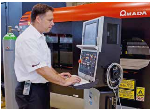
Eine Lasergas-Versorgungsanlage muss nicht immer aufwändig sein: Je nach Lasertyp kann schon eine Einzelflaschenversorgung mit Reinstgase-Flaschendruckregler ausreichen.
