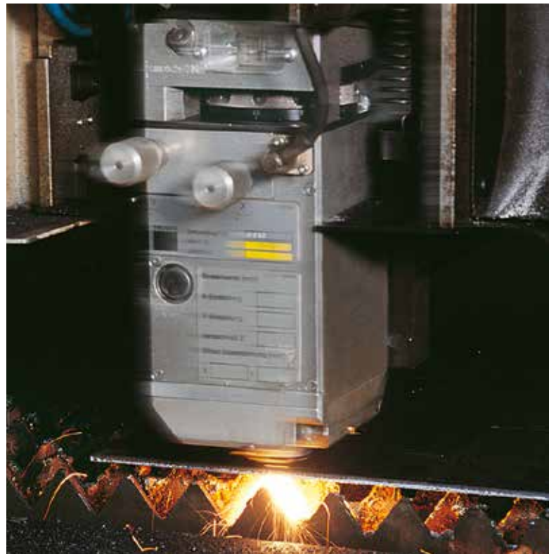
Das Laserschneiden – hier mit einem CO 2 -Laser – ermöglicht die präzise Bearbeitung von Werkstoffen wie Baustahl, Edelstahl oder Aluminium.
