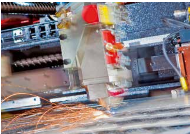
Kombiniertes Stanzen und Laserschneiden in Höchstgeschwindigkeit. Mit einem Gemisch aus Kohlendioxid, Helium und Stickstoff als Betriebsgas. Als Prozessgas fungiert Stickstoff. Anlage: Amada EML Z-3610 NT.
