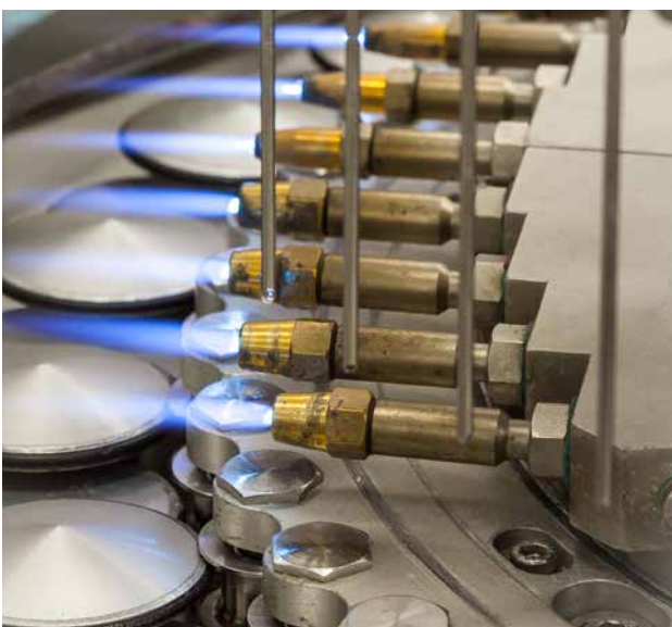
Secudur®-Gase schützen Arzneimittel vor Kontamination durch Luftsauerstoff oder Feuchtigkeit – hier Secudur® Ar (Argon) bei der Ampullierung.
