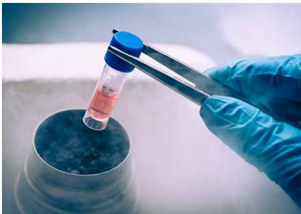
Kryokonservierung mit Secudur® N: Die extrem tiefe Temperatur des verflüssigten Stickstoffs bewirkt eine deutliche Senkung der Reaktionsgeschwindigkeit chemischer und biochemischer Prozesse.
