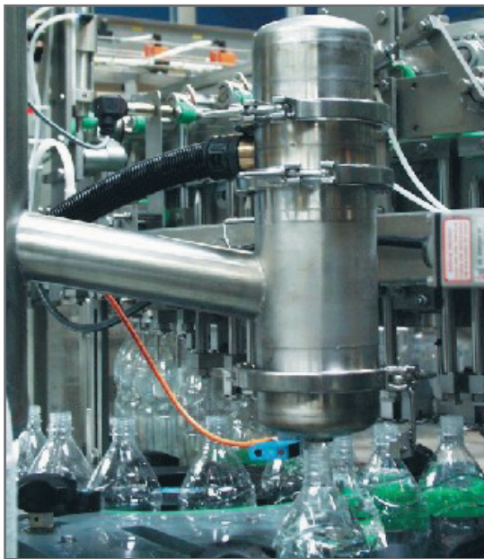
Die Abfüllung und Lagerung stiller Getränke in PET-Flaschen wird durch Zugabe von flüssigem Stickstoff vereinfacht.
