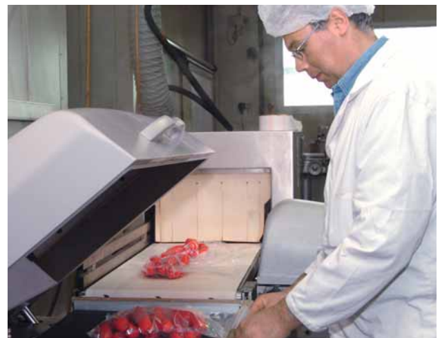
Houdbaarheidsverlenging bij worst en vleeswaren: evacueren en herbegassing met Protadur®.
