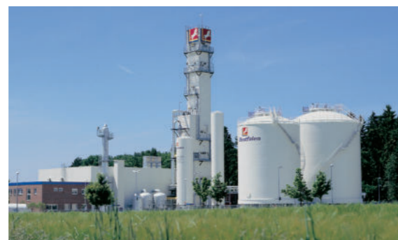
De stikstof wordt in onze drie luchtsplitsinstallaties in Hörstel, Laichingen en Le Creusot geproduceerd.
